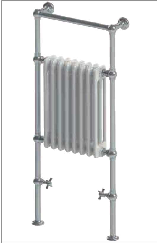
■ SSPVB3 • Radiatore a pavimento con inserto in ghisa mm.1185x545 DT60° Kcal/h 623,6 - Watt 723 Radiateur de sol avec insert en fonte 1185x545mm. DT60° Kcal/h 623,6 - Watt 723 Floor mounted radiator with cast iron insert 1185x545mm. DT60° Kcal/h 623,6 - Watt 723
